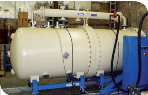
Accélérateur d'électrons SIRIUS (LSI)
